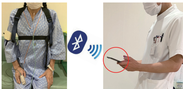
図3 Bluetoothを介してタブレット端末上にリアルタイム表示
