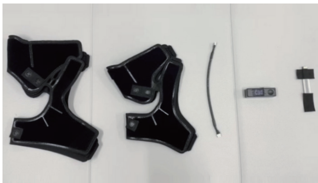
図1 ATメジャーの構成 (右からCSセンサ、表示ユニット、通信ケーブル、装具)
